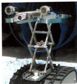
Figura 13 – Mecanismo de posicionamento da câmera
