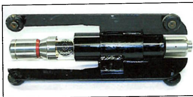
Figura 11 – Propulsão a jato d'água (Water Jet propelled - Westvac)
