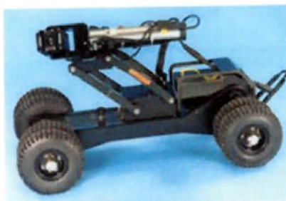
Figura 06 – Modelo de locomoção por rodas (Steerable Mudmaster – Cues)
