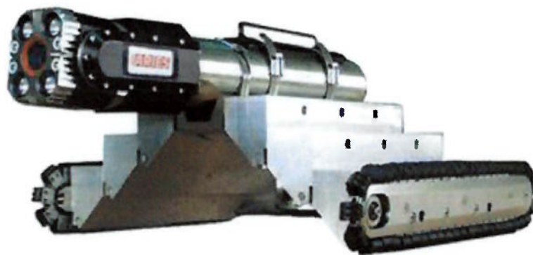
Figura 10 – Modelo de locomoção por esteira (TR2000-Aries)
