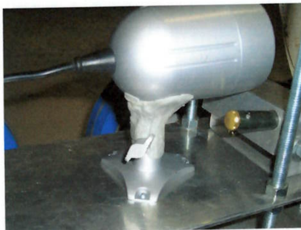
Figura 48 – Detalhe do reforço no suporte da câmera
