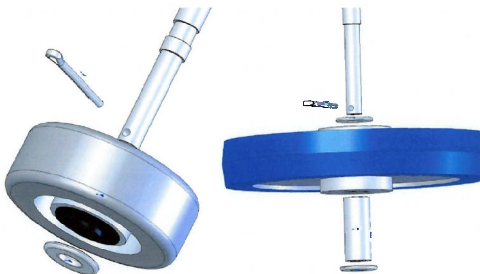
Figura 27 - Vista explodida das rodas de 4" e 9"
