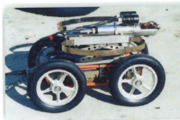
Figura 09 – Modelo de locomoção por rodas com correia (Crawler – Cobra)
